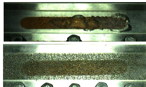
通常流路(上)とPMC(下)での気泡生成状況
